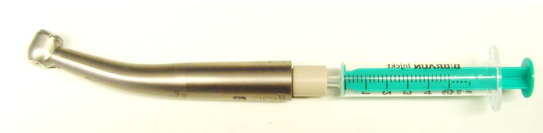
Bild 12: Aufgesetzter Spritzenadapter mit aufgesetzter Spritze zum Eluieren.
