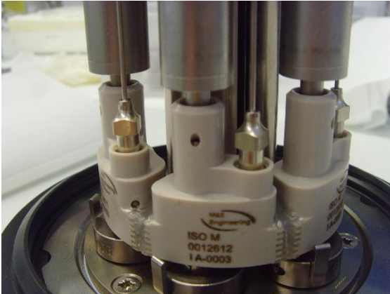
Bild 7: SMP-Adapter auf Deckel und mit aufgesetzten Hülsen und Kanülen.
