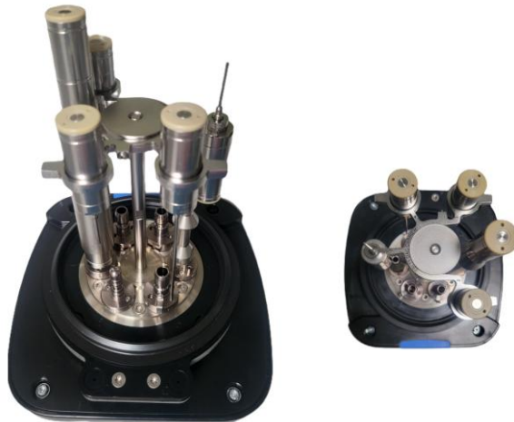
Bild 21: Platzierung der Datenlogger auf dem DAC Universal Deckel
